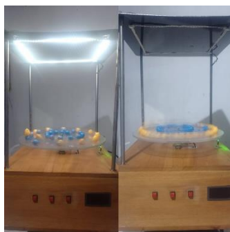
Gambar 3. Purwarupa 3D zoetrope pada pengujian sinkronisasi strobo
