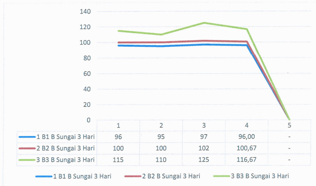
Gambar 4. 5 Grafik Kuat Kuat Tekan Beton Umur 3 hari Terhadap Variasi % Agregat Kasar
