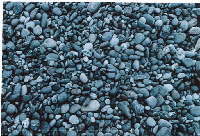
Gambar 3. 4 Agregat Kasar (Batu Sungai)
