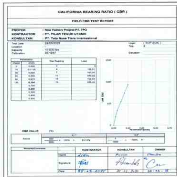
Gambar 4.11 Hasil Pengetesan California Bearing Ratio Lapangan (Titik 1 Dan 2)
