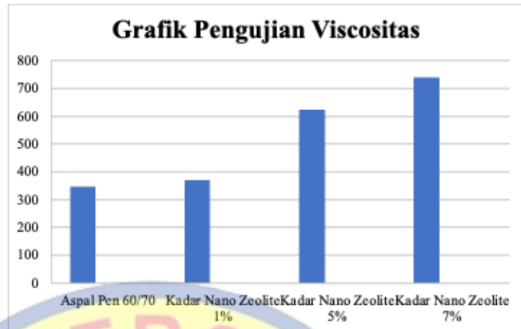
Gambar 4. Grafik nilai Viscositas (Saybolt Viscosimeter)
