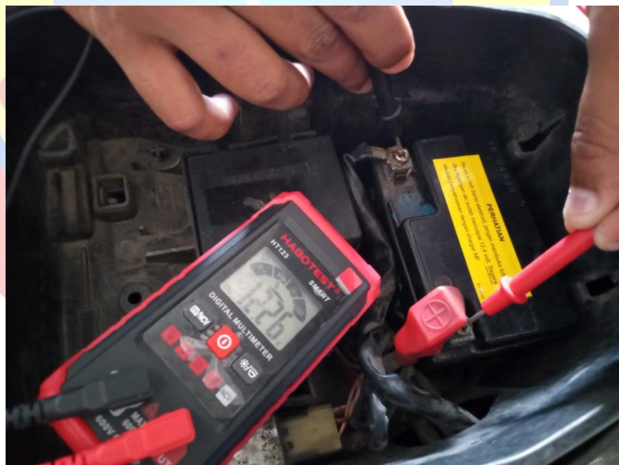
Gambar 4. 15 Pengukuran Tegangan Baterai/Accu
