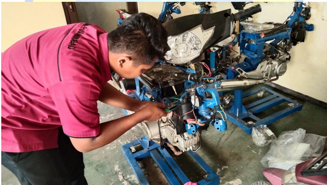
Lampiran 2 Proses Instalasi Sistem Keamanan Sepeda Motor Dengan Menggunakan Modul ESP 32
