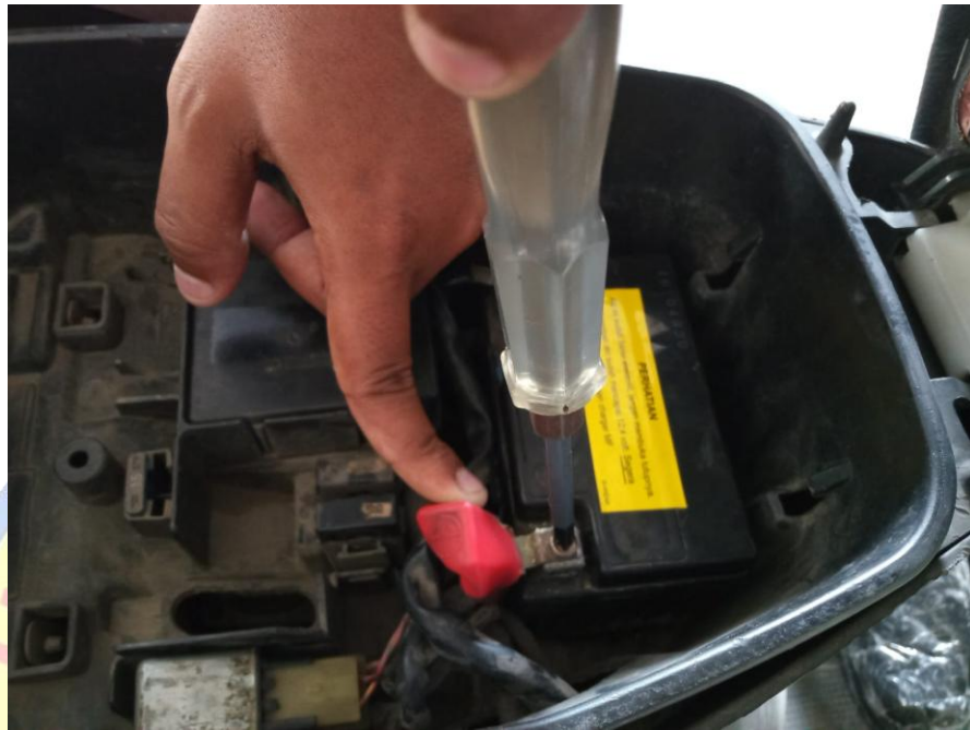
Gambar 4. 16 Pemasangan Kabel (+) dan (-)
