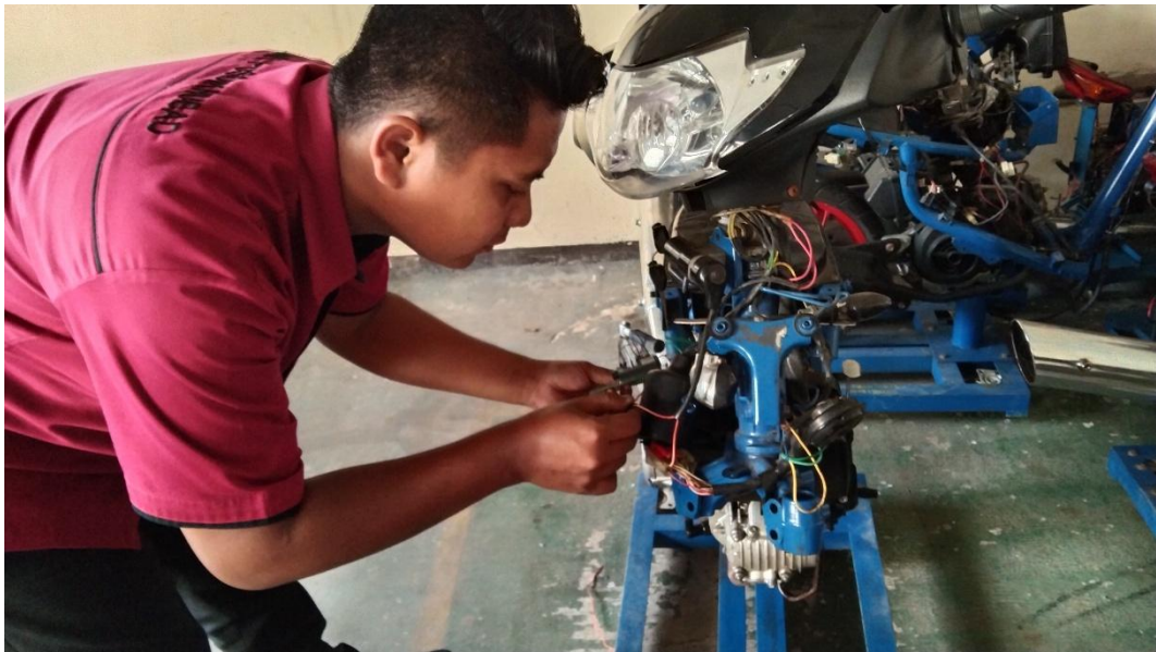
Lampiran 1 Proses Implementasi Sistem Keamanan Sepeda Motor Dengan Menggunakan Modul ESP 32
