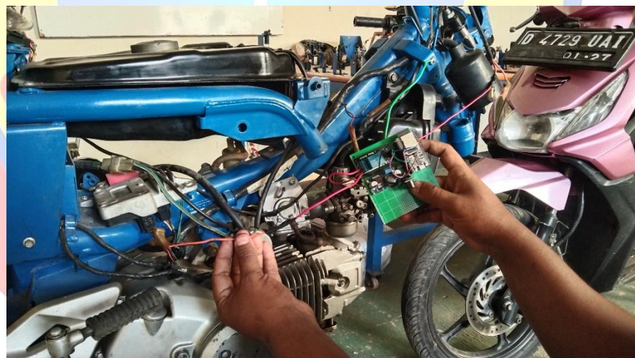
Gambar 4. 19 Output Terminal NO Disambungkan Ke Ground CDI
