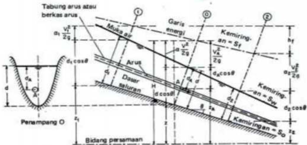
Gambar 2.10 Energi dalam aliran saluran terbuka berubah beraturan ( Sumber : Open Chaneel Hydraulics International Student Edition, Ven Te Cow, 1985)
