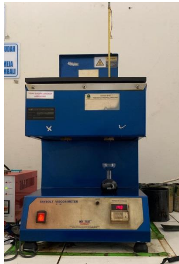
Gambar 4.3. Alat Pengujian Viskositas ( Saybolt Viscosimeter ) Sumber : Dokumentasi Penulis
