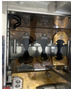
Gambar 4.4. Alat Dan Hasil Pengujian Daktilitas Sumber : Dokumentasi Penulis
