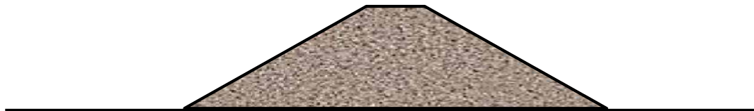
Gambar 2. 2. Tubuh Embung Type Urugan Homogen
