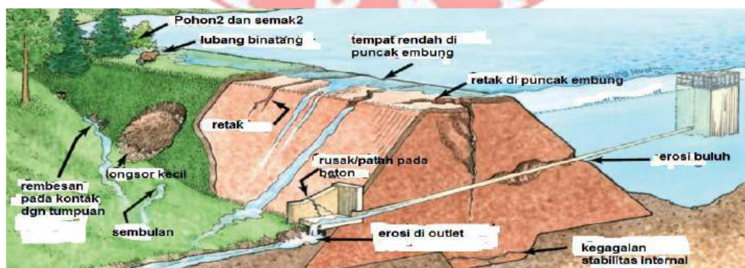
Gambar 2. 4. Ilustrasi Kerusakan dan Kurangnya Pemeliharaan Pada Embung (Sumber: Modul Pengantar Perancangan Embung, 2017)
