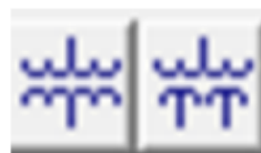
Gambar 2.18 Simbol Transformator 2 Kawat Di ETAP
