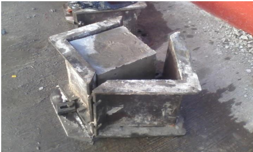
Gb. 12 pembongkaran cetakan pada setelah didiamkan selama kurang lebih 24 jam
