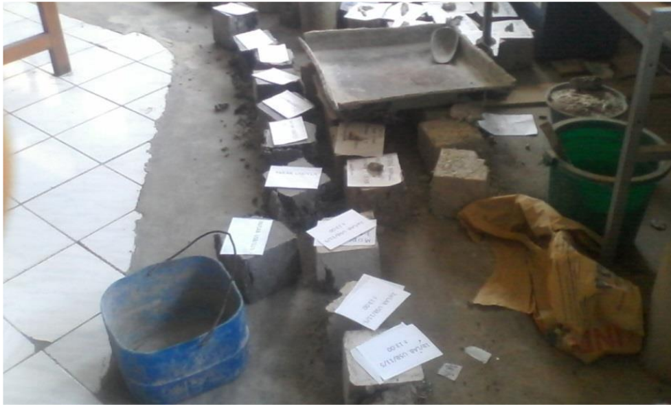
Gb. 19 penyimpanan benda uji setelah dilakukan uji tekan
