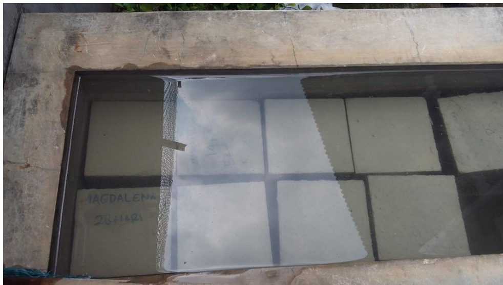
Gb.14 proses perendaman 6 benda uji (3 beton normal & 3beton campuran) selama 7hari, 14hari, & 28hari
