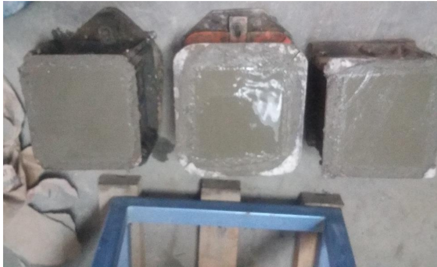
Gb. 11 hasil pencetakan campuran benda uji (beton normal)
