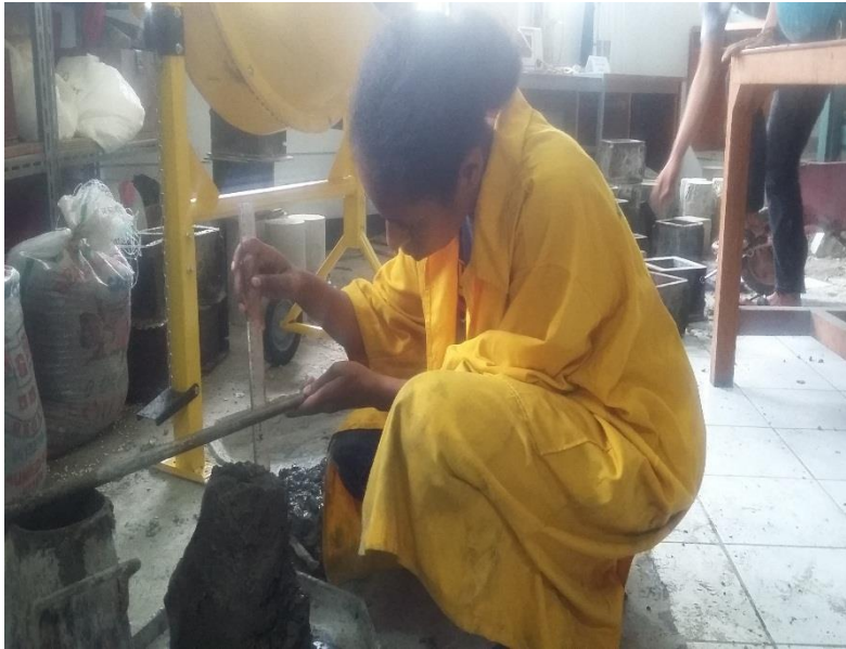
Gb. 7 pengujian slump pada campuran beton normal
