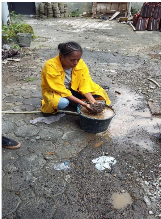
Gb. 2 proses pencucian bahan campuran pasir & kerikil untuk pembuatan benda uji
