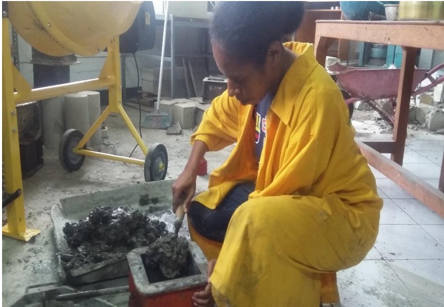
Gb. 9 pemindahan campuran beton dari wadah untuk dimasukkan ke dalam cetakan
