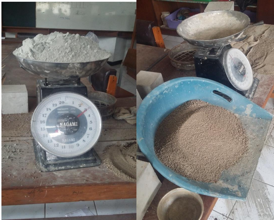
Gb. 5 sebagian bahan campuran benda uji yang telah ditimbang sesuai dengan perencanaan
