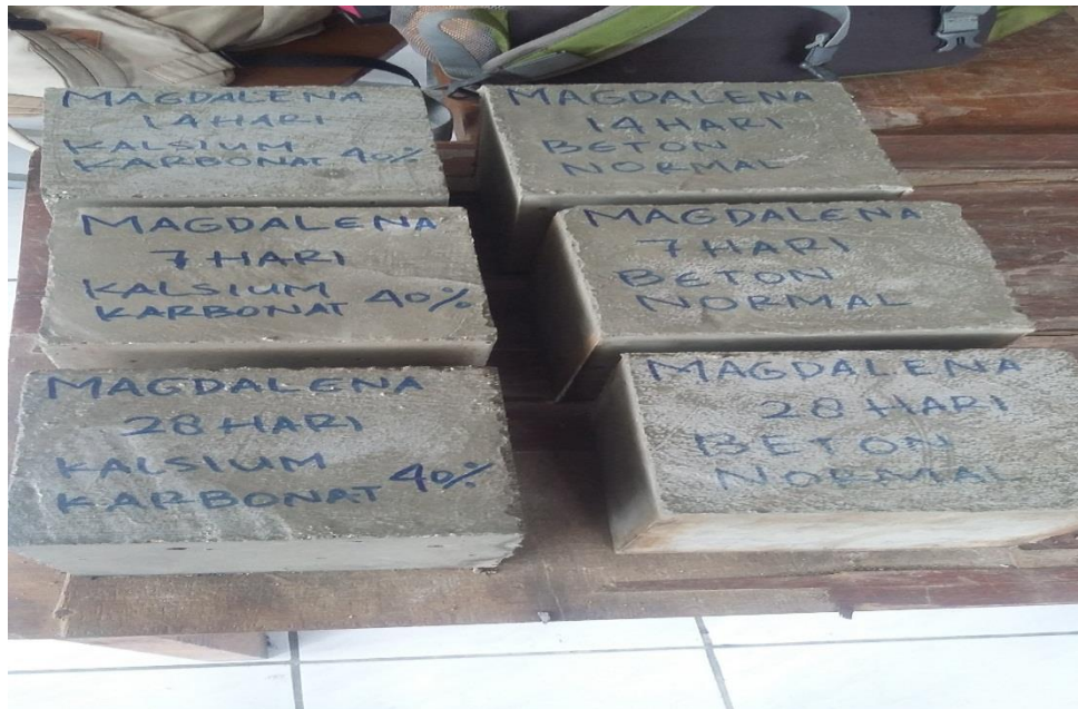
Gb.13 6 benda uji (3 beton normal & 3 beton campuran) yang telah dibuka dari cetakan siap direndam dalam air selama waktu yang ditentukan pada tiap benda uji
