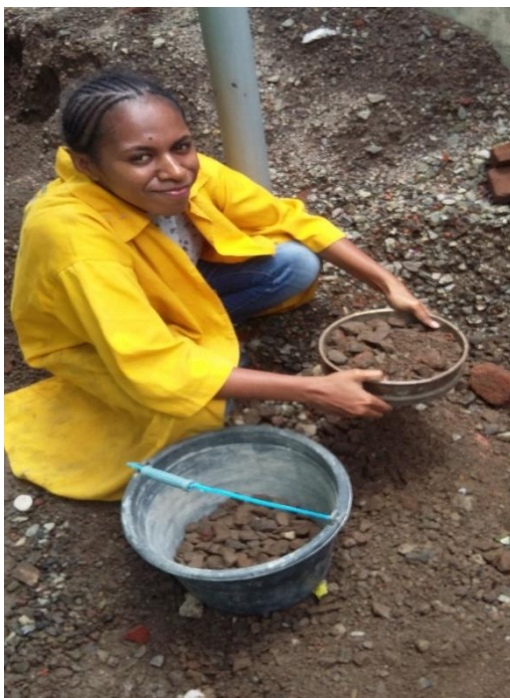
Gb. 1 persiapan bahan campuran pasir & kerikil untuk pembuatan benda uji
