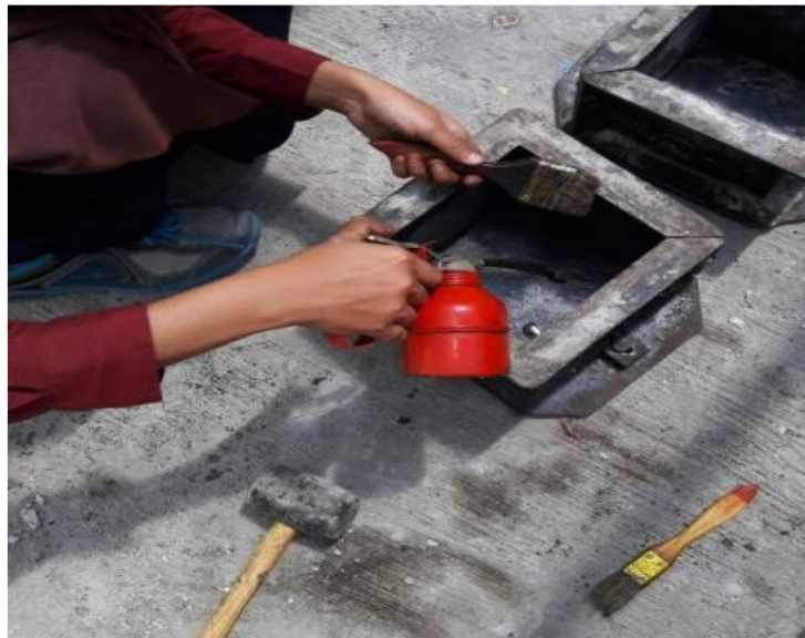
Gb.8 pelapisan permukaan cetakan menggunakan oli dan kuas (dilakukan sebelum pembuatan benda uji)
