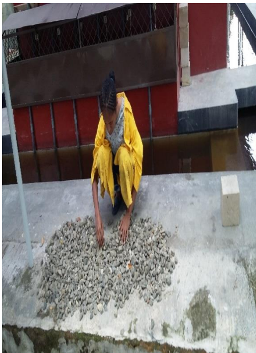
Gb. 4 bahan campuran pasir & kerikil yang sudah dijemur siap dipakai untuk pembuatan benda uji
