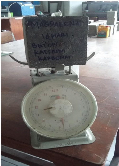
Gb. 16 proses penimbangan benda uji setelah direndam
