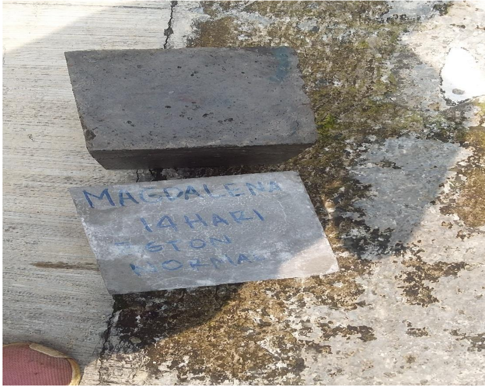
Gb. 15 proses penggeringan benda uji yang sudah direndam sesuai waktu yang ditentukan
