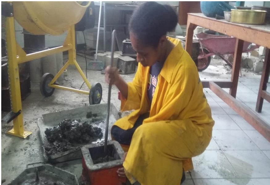
Gb.10 pencetakan dan pemadatan benda uji dengan menggunakan palu karet dan penusuk pada campuran yang telah dicetak
