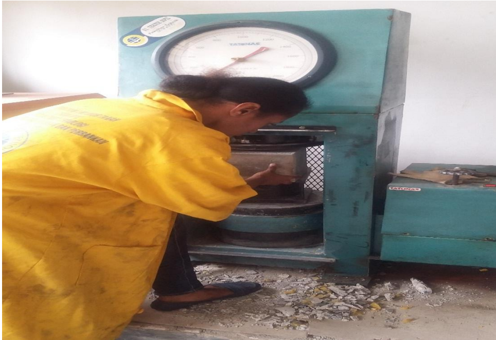
Gb. 17 meletakkan benda uji pada alat Compression testingmachine
