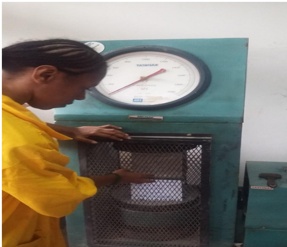
Gb. 18 test uji tekan dengan alat Compression testingmachine
