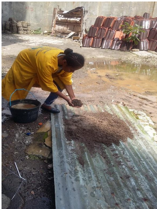
Gb. 3 penjemuran bahan campuran pasir & kerikil untuk pembuatan benda uji
