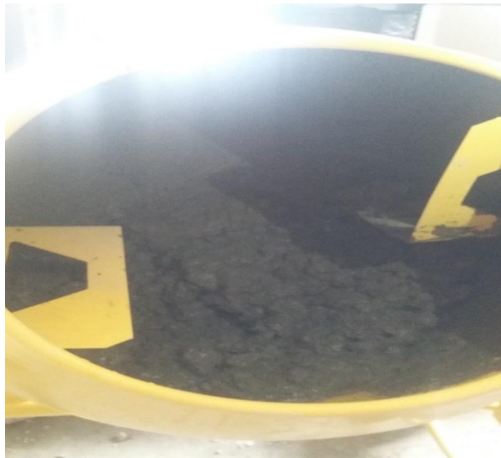
Gb. 6 proses pembuatan benda uji menggunakan moleng
