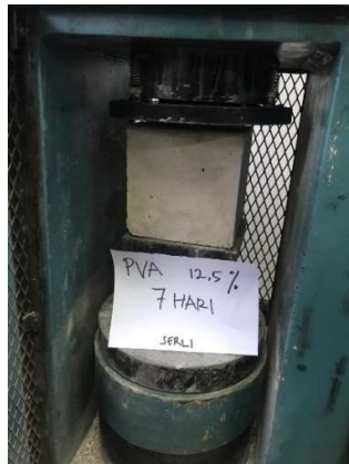
Kuat Tekan Beton Pvac 2.5% umur 7 hari
