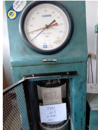
Kuat Tekan Beton Pvac 2.5% umur 14 hari
