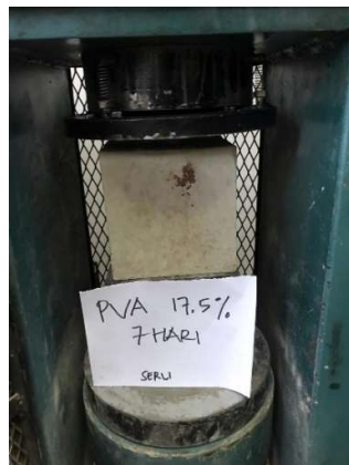
Kuat Tekan Beton Pvac 17.5% umur 7 hari
