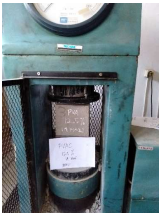
Kuat Tekan Beton Pvac 12.5% umur 14 hari
