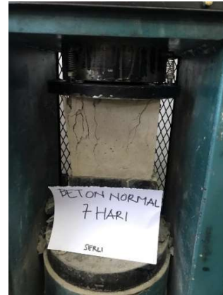
Kuat Tekan Beton Normal umur 7 hari
