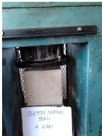
Kuat Tekan Beton Normal umur 14 hari
