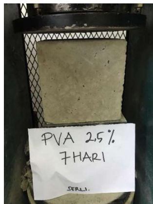
Kuat Tekan Beton Pvac 2.5% umur 7 hari
