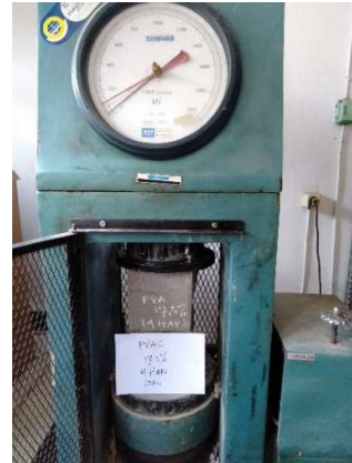
Kuat Tekan Beton Pvac 17.5% umur 14 hari
