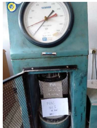
Kuat Tekan Beton Pvac 12.5% umur 14 hari
