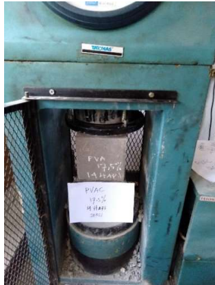
Kuat Tekan Beton Pvac 17.5% umur 14 hari
