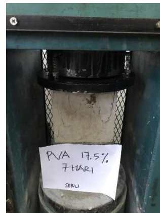
Kuat Tekan Beton Pvac 17.5% umur 7 hari
