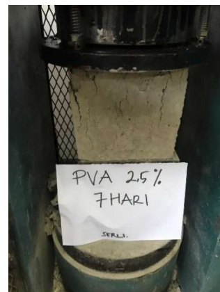
Kuat Tekan Beton Pvac 2.5% umur 7 hari
