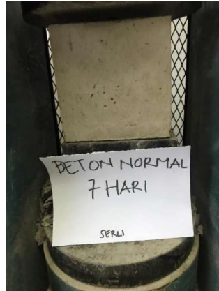
Kuat Tekan Beton Normal umur 7 hari
