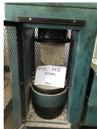
Kuat Tekan Beton Pvac 7.5% umur 7 hari
