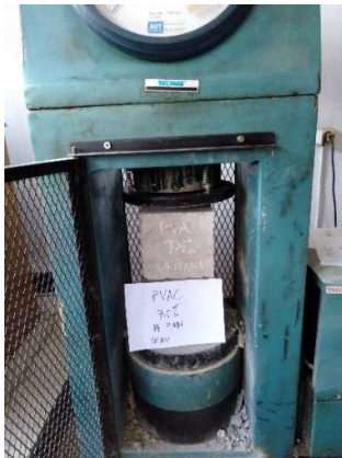
Kuat Tekan Beton Pvac 7.5% umur 14 hari
