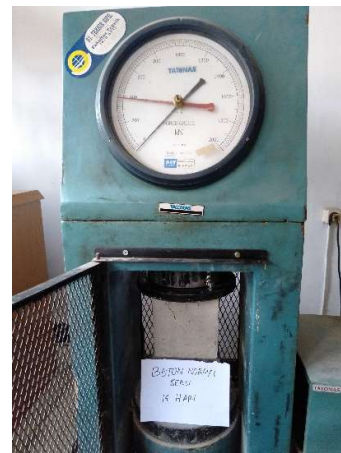
Kuat Tekan Beton Normal umur 14 hari
