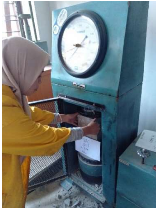
Kuat Tekan Beton Pvac 2.5% umur 14 hari
