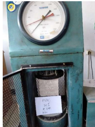
Kuat Tekan Beton Pvac 7.5% umur 14 hari
