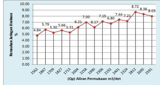
Gambar 4. Hubungan aliran permukaan dengan Tingkatan kerusakan drainase
