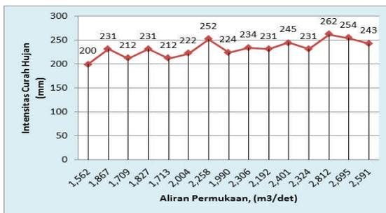
Gambar 3. Hubungan Intensitas Curah hujan dan Aliran permukaan
