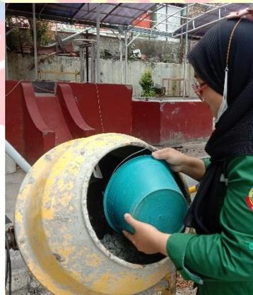
**Gambar 1.1** Proses Pencampuran Beton Dengan Limbah Batu Bata Merah
