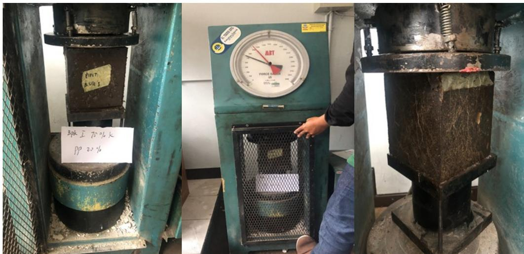
(Gambar 4.5. Pengujian Benda Uji 1 Pasta Polimer 20%)
