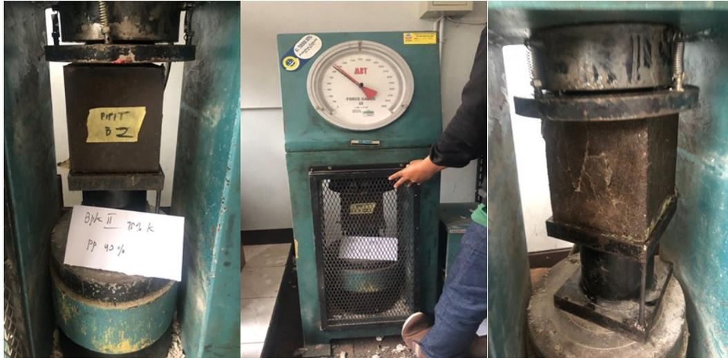
(Gambar 4.7. Pengujian Benda Uji 2 Pasta Polimer 40%)
