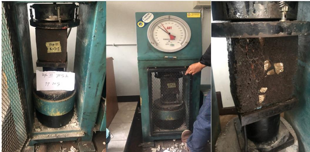
(Gambar 4.9. Pengujian Benda Uji 3 Pasta Polimer 50%)
