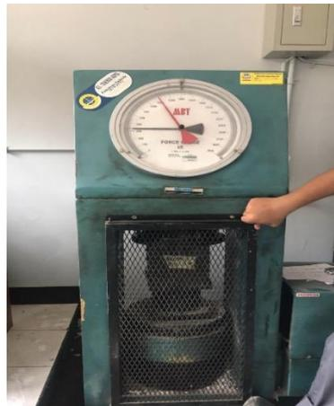
Gambar 8.7. Pengujian Benda Uji 2 Pasta Polimer 40%
