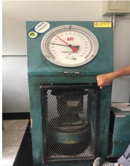
*Gambar 8.5. Pengujian Benda Uji 1 Pasta Polimer 20%*
