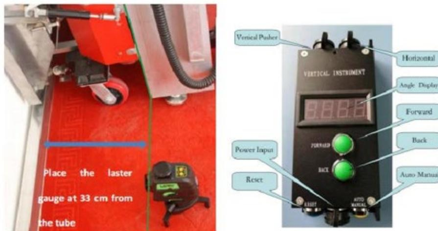
**Gambar 2.20** Garis Laser dan Vertical Instrument
