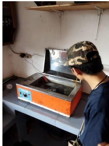
Gambar 4.11: Proses merendam benda uji dalam bak perendam ( water bath ) selama 30 – 40 menit.
