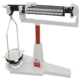
Gambar 2.2: Timbangan dan Neraca dengan ketelitian 0,2%
