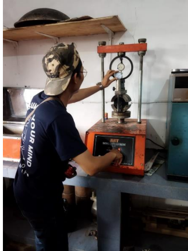
Gambar 4.12: Proses pengujian benda uji menggunakan alat marshall.
