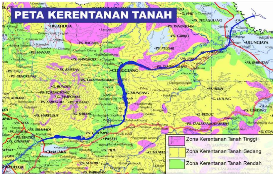
Gambar 1.1 Jalur Tol Cisumdawu Dan Peta Kerentanan Tanah (Sumber : Data Internal PT. Citra Karya Jabar Tol)
