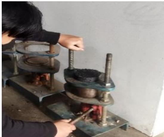
Gambar 3. 3: Mengeluarkan benda uji menggunakan alat dongkrak.
