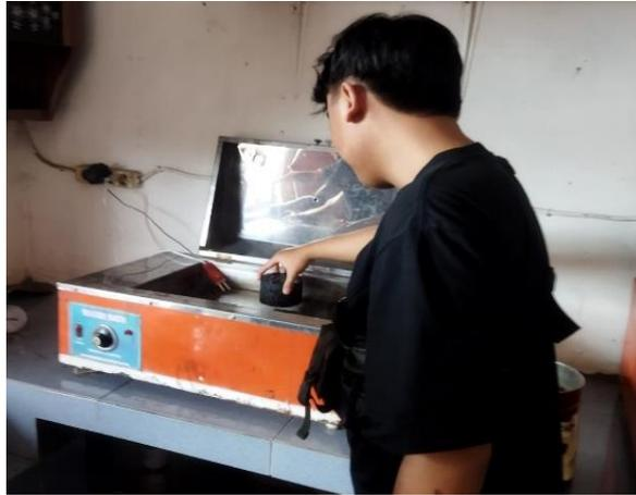
Gambar 4. 13: Proses merendam benda uji dalam bak perendam (*water bath*).
