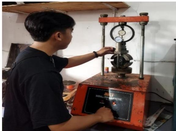
Gambar 4. 14: Proses pengujian benda uji menggunakan alat marshall.
