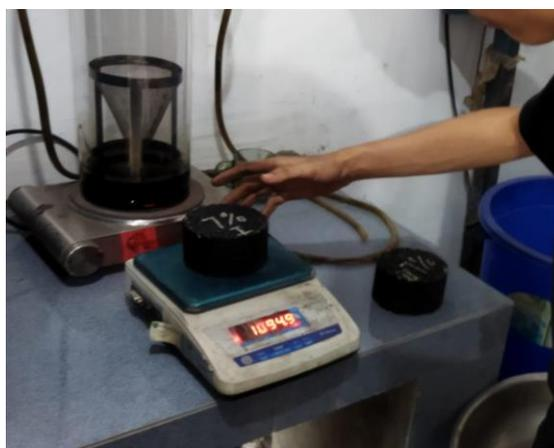
Gambar 3. 4: Timbang berat benda uji kondisi kering
