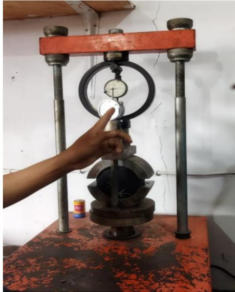
Gambar 3. 9: Pemasangan benda uji pada alat uji marshall.
