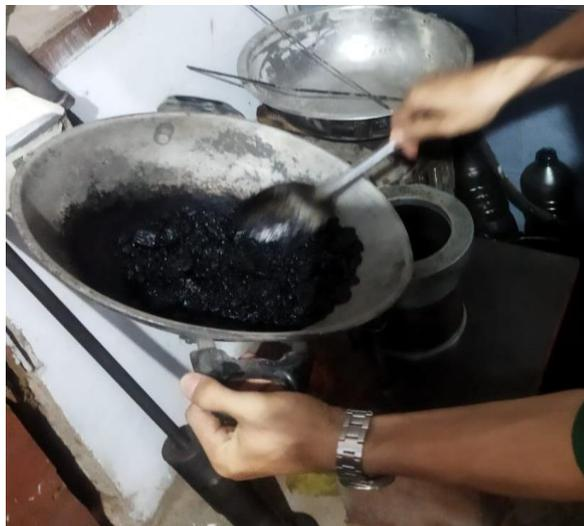
Gambar 3. 2: Penempatan mold sebagai wadah campuran aspal.
