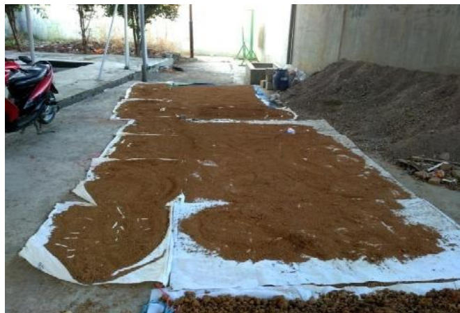
Gambar 4.3 Bahan Uji Pemadatan Standar
