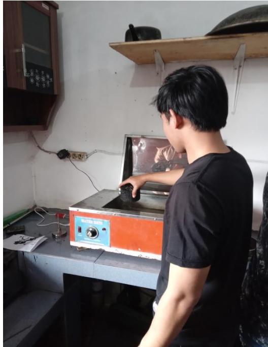
Gambar 4.11: Proses Merendam Benda Uji Dalam Bak Perendam ( Water Bath ) Selama 30 – 40 Menit.
