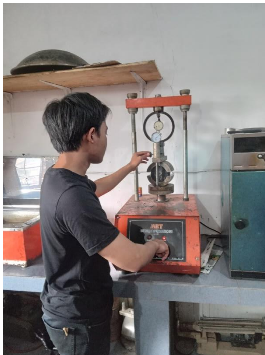
Gambar 4.12: Proses Pengujian Benda Uji Menggunakan Alat Marshall.
