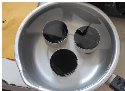
Gambar 3.11 Cawan Yang Sudah Terisi Aspal
