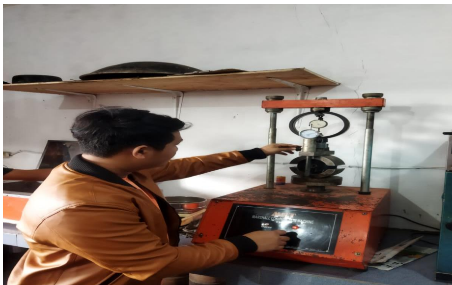
Gambar 4.12: Proses Pengujian Benda Uji Menggunakan Alat Marshall.
