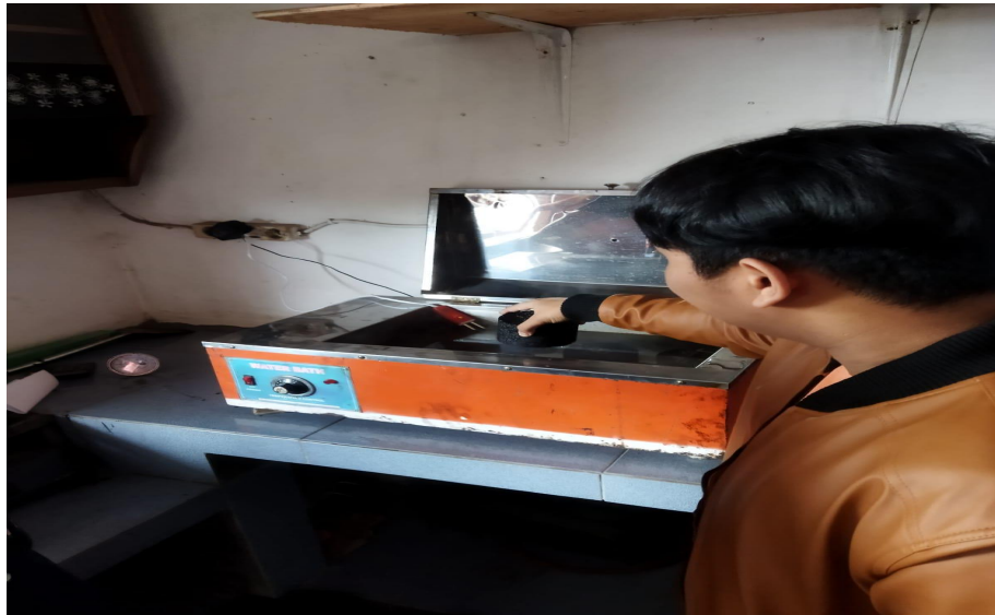
Gambar 4.11: Proses Merendam Benda Uji Dalam Bak Perendam ( water bath ) Selama 30 – 40 Menit.
