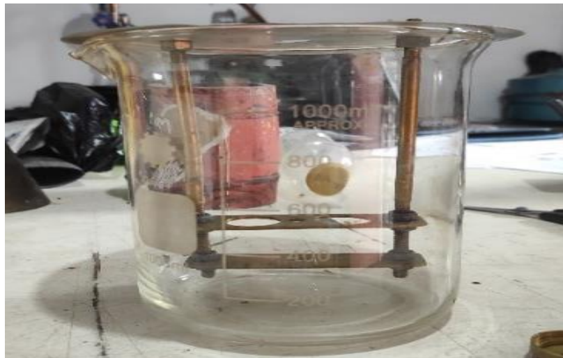
Gambar 3.19 Dudukan Benda Uji
