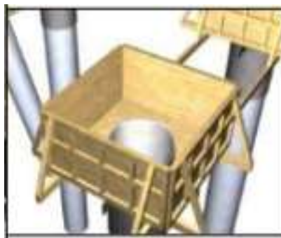
Gambar 2.31 Contoh Bekisting dan Penulangan Pile Cap
