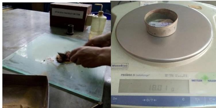
**Gambar 3.7** Proses pengujian batas plastis
