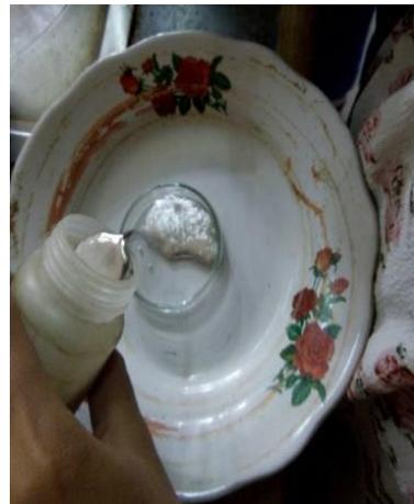
**Gambar 3.8** Proses pengujian batas susut
