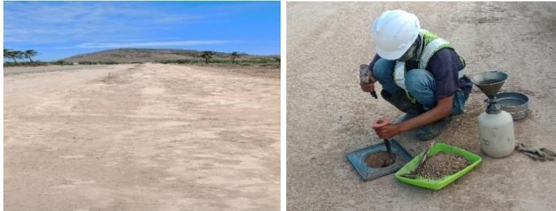
7) Buat, gali lubang pada tanah didalam tanda batas yang dibuat, dengan kedalaman  $\pm 12$  cm berbentuk cekungan. Kerjakan hati – hati dan hindarkan terganggunya tanah disekitar dinding dasar lubang. Perlu sangat hati – hati untuk tanah yang mudah longsor (tanah non kohesi).
