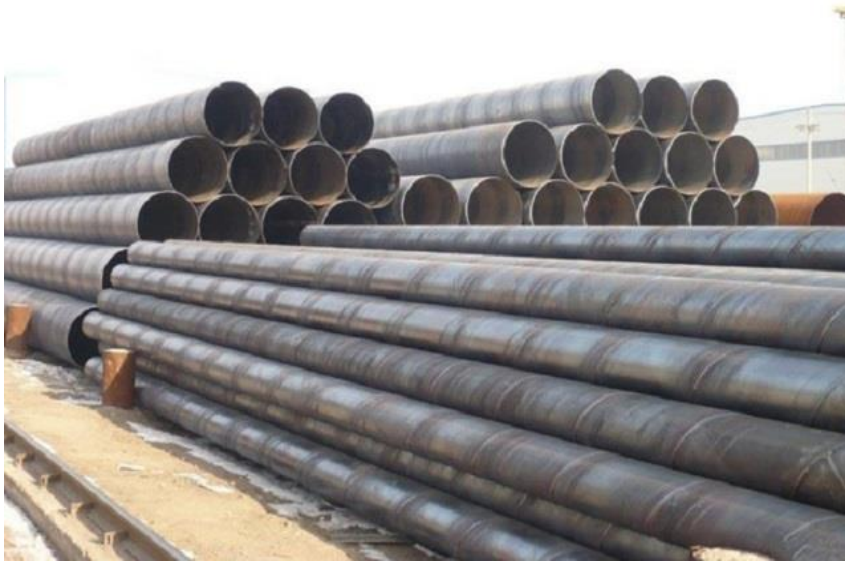
Gambar 2. 8 Tiang Pancang Baja
