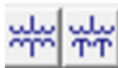
Gambar 2.18 Simbol Transformator 2 Kawat Di ETAP
