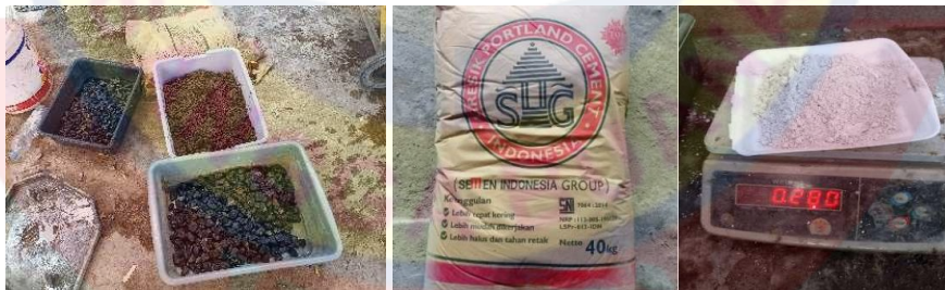
Gambar 4.4 Bahan Yang di Gunakan pada Pembuatan Campuran Beton
