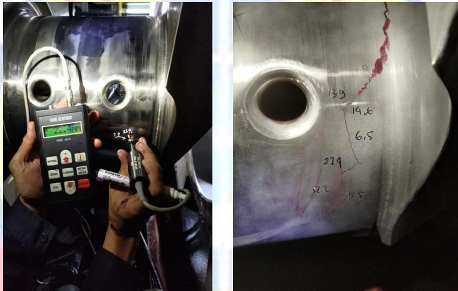
Gambar 4.7 Hasil pengujian kedalaman retak
