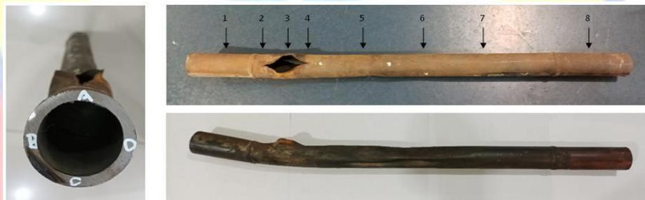
Gambar 4.6 titik pengujian *thickness*
