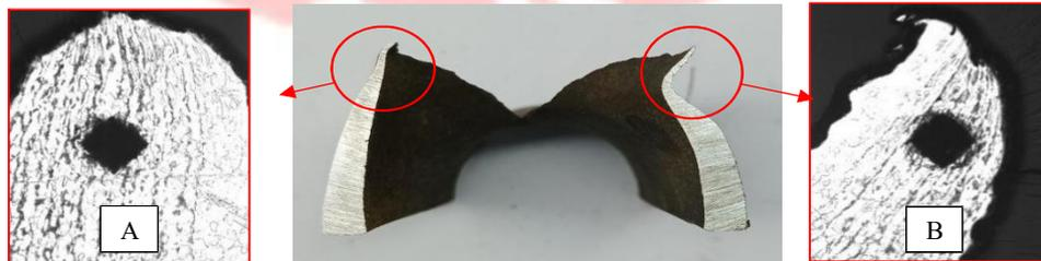
Gambar 4.14 Titik Pengujian Kekerasan area *failure*
