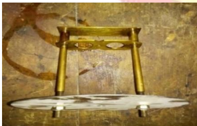
Gambar 3. 11 Dudukan Benda Uji
