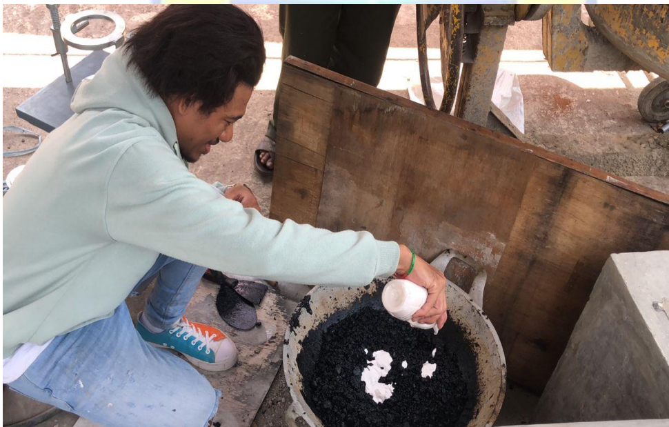
Gambar L. 11 Pencampuran bahan tambah getah karet pada campuran beraspal.
