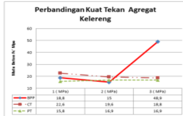
Gambar 3 Grafik Perbandingan Hasil Kuat Uji Tekan Beton yang Kadar Polyesternya Berbeda
