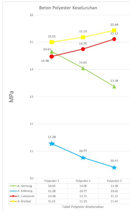
Gambar 3 Grafik Hasil Kuat Uji Tekan Beton Polyester Keseluruhan
