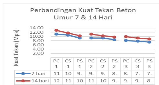
Gambar 2. Grafik Hubungan Kuat Tekan Beton terhadap Umur Beton 7 dan 14 Hari
