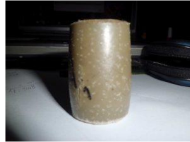
Gambar 3. Beton Polimer ( Polymer, PC )
