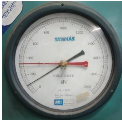
Hasil Uji Kuat Tekan Beton Normal + Batu kapur 40% Pada Umur 7 Hari
