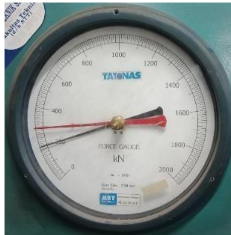
Hasil Uji Kuat Tekan Beton Normal Pada Umur 7 Hari
