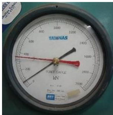
Hasil Uji Kuat Tekan Beton Normal + Batu kapur 40% Pada Umur 7 Hari
