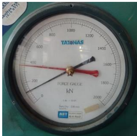
Hasil Uji Kuat Tekan Beton Normal + Batu kapur 30% Pada Umur 14 Hari
