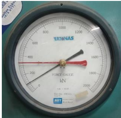
Hasil Uji Kuat Tekan Beton Normal + Batu kapur 30% Pada Umur 14 Hari
