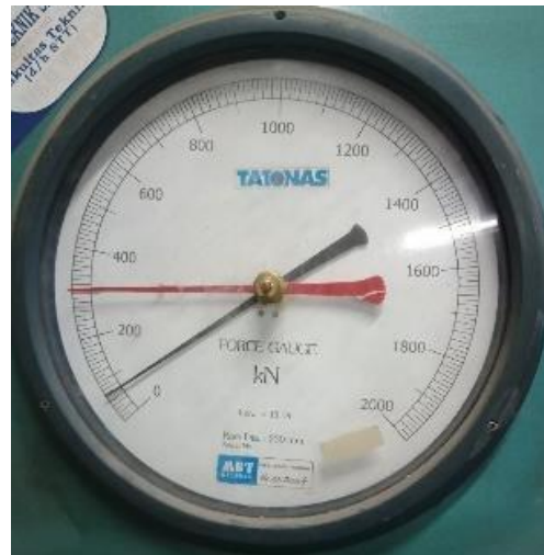
Hasil Uji Kuat Tekan Beton Normal + Batu kapur 20% Pada Umur 7 Hari
