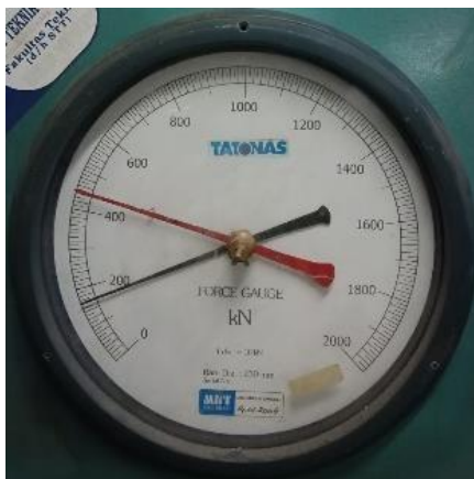
Hasil Uji Kuat Tekan Beton Normal + Batu kapur 40% Pada Umur 14 Hari
