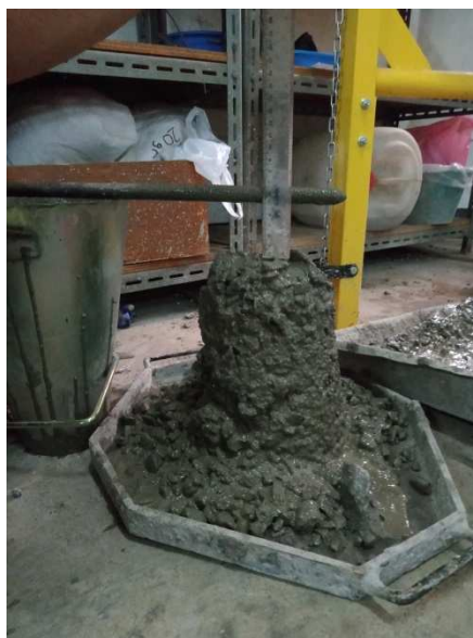
Gambar 4.4 Pengujian Slump Beton
