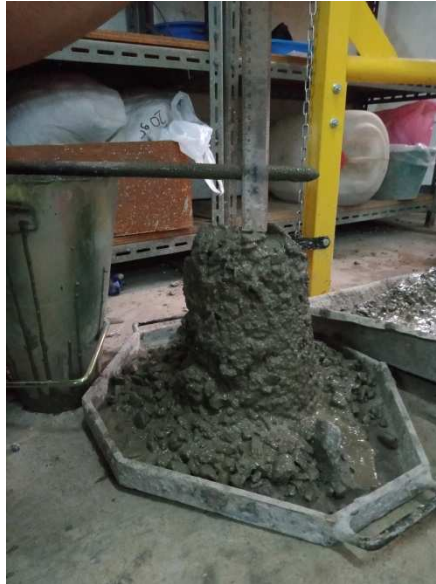
Gambar 4.4 Pengujian Slump Beton
