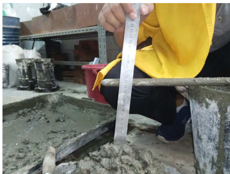
Gambar 4.5 Pengujian Slump Beton
