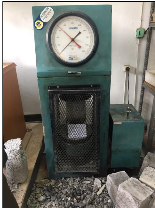
Proses pengujian uji tekan benda umur 14 hari
