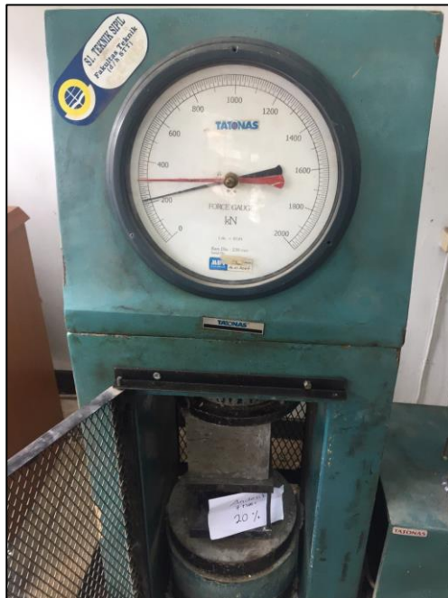
Proses pengujian uji tekan benda umur 7 hari
