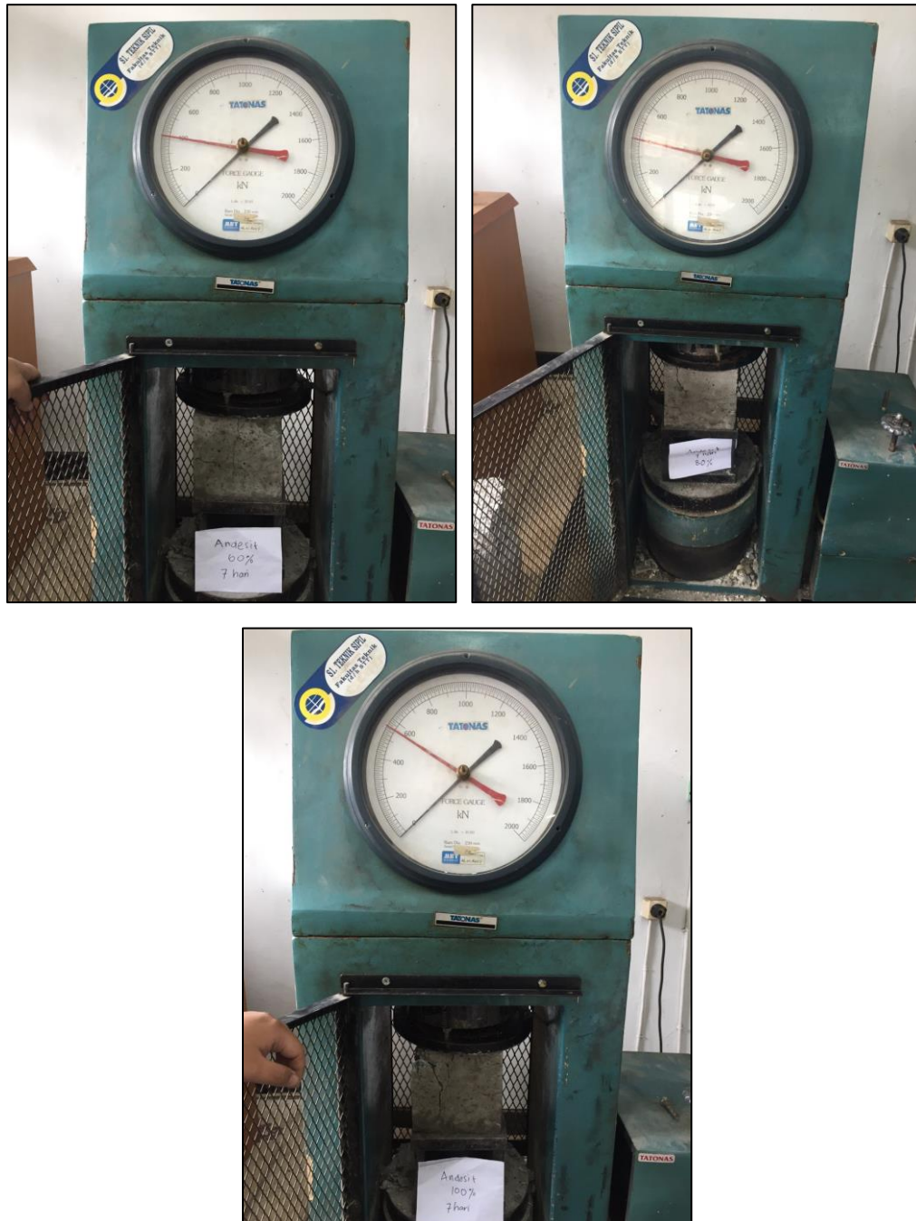
Proses pengujian uji tekan benda umur 7 hari
