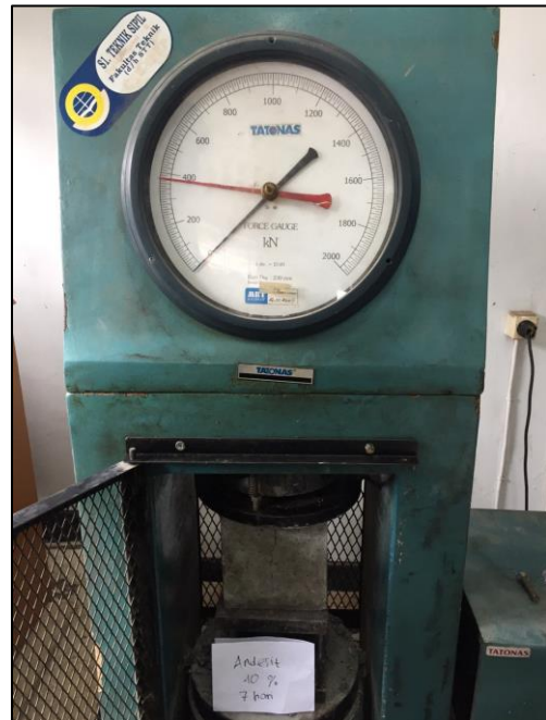
Proses pengujian uji tekan benda umur 7 hari
