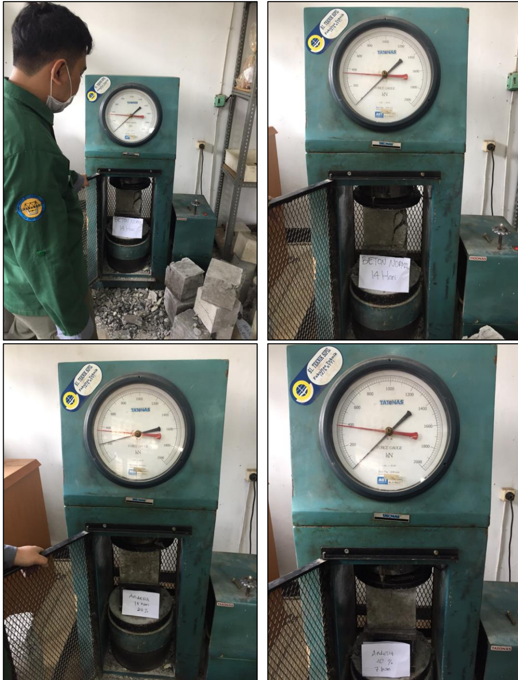
Proses pengujian uji tekan benda umur 14 hari
