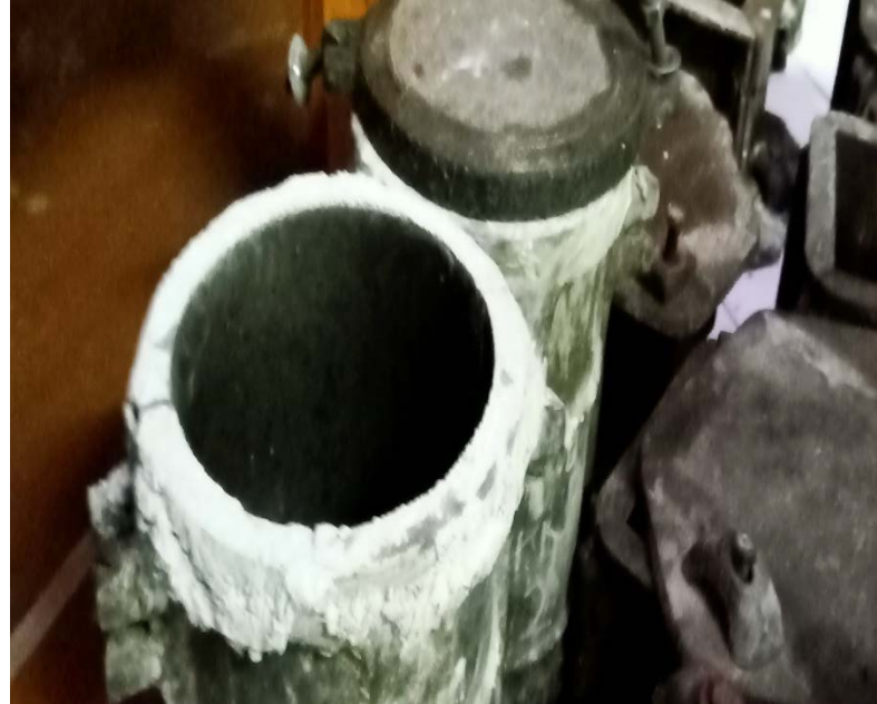
Gambar 13. Persiapan Cetakan Beton
