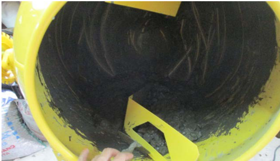
Gambar 8. Material Campuran Beton yang telah diaduk
