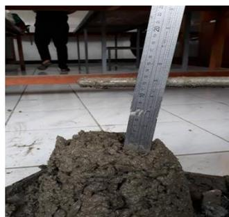
**Gambar 4.15.**Hasil Slump Test
