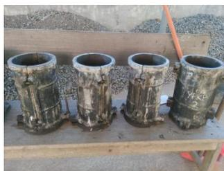
**Gambar 4.9.**Cetakan Beton Silinder
