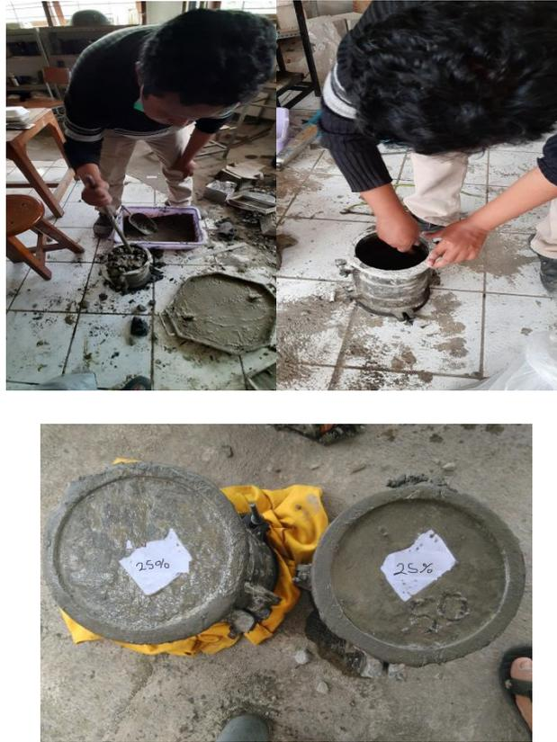
**Gambar 4.16.**Pembuatan Benda Uji
