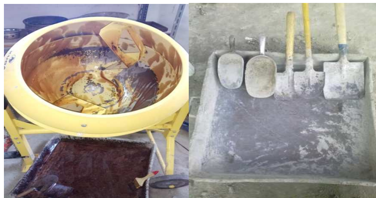
Gambar 4.3 Alat Yang di Gunakan pada Pembuatan Campuran Beton
