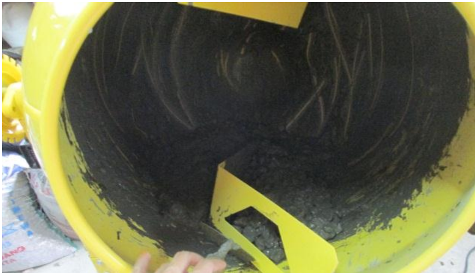
Gambar 8. Material Campuran Beton yang telah diaduk
