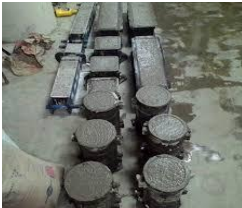
Gambar 14. Pematatan Beton Dalam Cetakan
