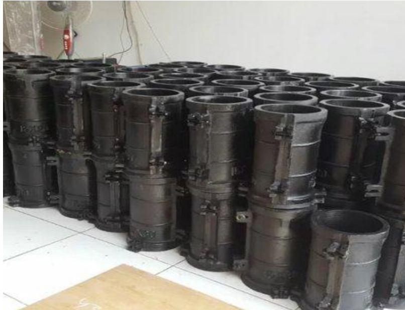
Gambar 13. Persiapan Cetakan Beton
