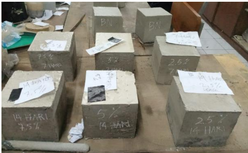
Beton umur 1 hari setelah dilepas dari cetakan
