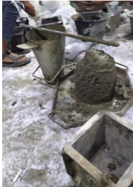
Pengujian slump beton segar
