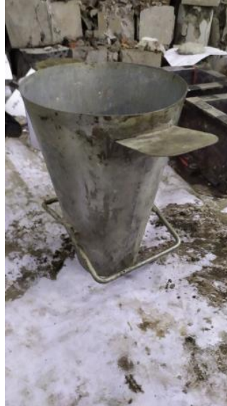
Gambar alat kerucut Abrams untuk melakukan uji slump beserta plat besi
