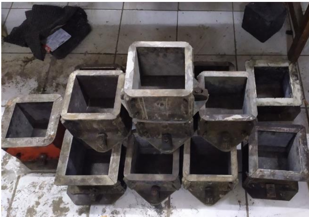
Gambar modal beton untuk cetakan beton kubus ukuran 15cm x 15cm x 15cm
