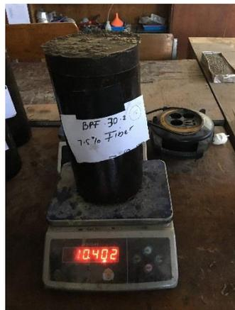
(Gambar 4.13. Benda uji 4 kadar *fiberglass* 10%)
