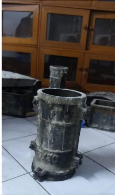
(Gambar 3.2. Cetakan beton silinder)
