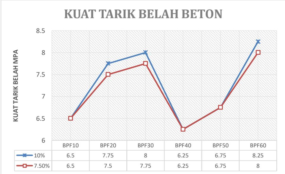
(Gambar 4.16. Grafik perbandingan kuat tarik belah dengan kadar fiberglass yaitu 7.5% dan 10%, dan kadar resin yang berbeda)
