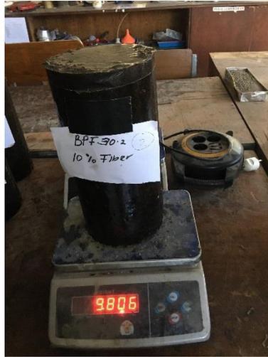
(Gambar 4.5. Benda uji 2 kadar *fiberglass* 10%)
