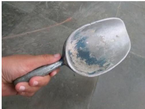
Gambar 4. Sendok Agregat
