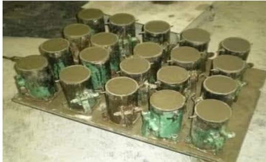
*Gambar 4.7 Cetakan Beton Silinder 15 cm x 30*
