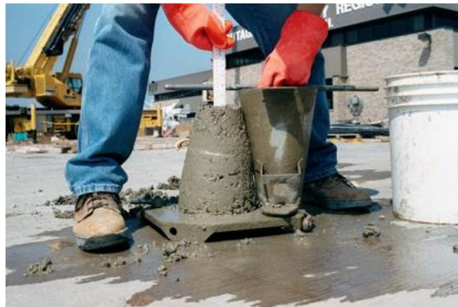
*Gambar 4.6 Pengujian Slump Beton*
