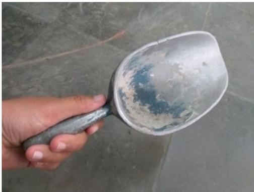
Gambar 4. Sendok Agregat
