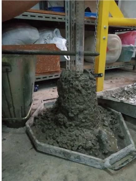
**Gambar 4.4** Pengujian *Slump* Beton
