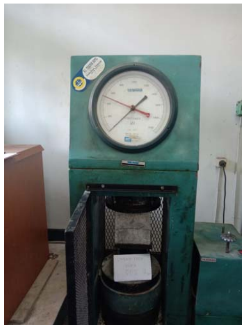
Hasil Uji Tekan Beton dengan 50 % Limbah Pasir Silika
