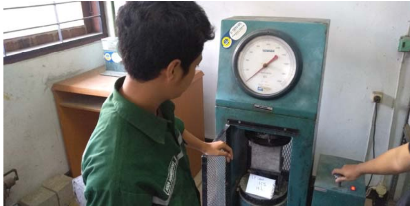
Uji Kuat Tekan Beton dengan 75 % Limbah Pasir Silika
