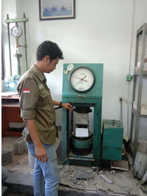
Uji Kuat Tekan Beton dengan 25 % Limbah Pasir Silika
