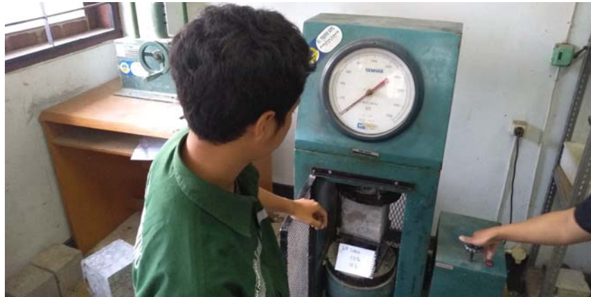
Uji Kuat Tekan Beton dengan 50 % Limbah Pasir Silika
