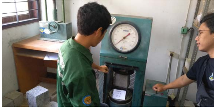
Uji Kuat Tekan Beton dengan 25 % Limbah Pasir Silika
