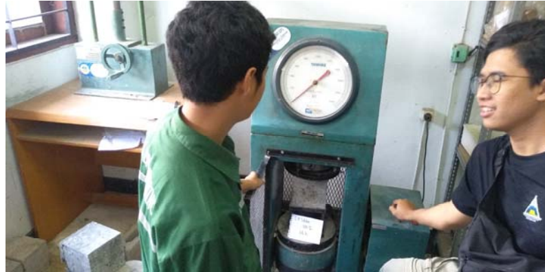
Hasil Uji Kuat Tekan Beton dengan 75 % Limbah Pasir Silika
