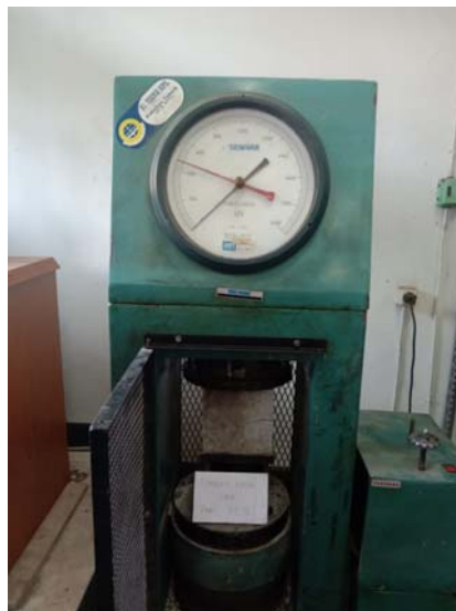
Hasil Uji tekan beton dengan 75 % Limbah Pasir Silika
