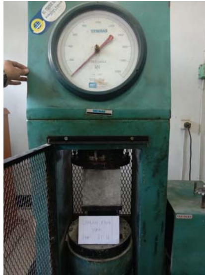
Uji tekan beton dengan 75 % Limbah Pasir Silika
