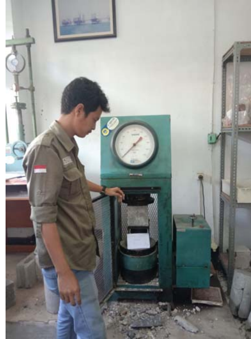
Uji Kuat Tekan Beton dengan 25 % Limbah Pasir Silika
