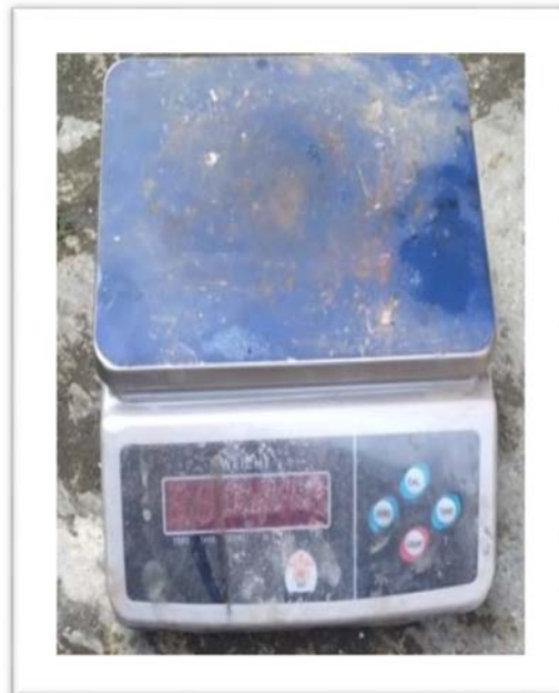
Timbangan yang digunakan saat menimbang agregat
