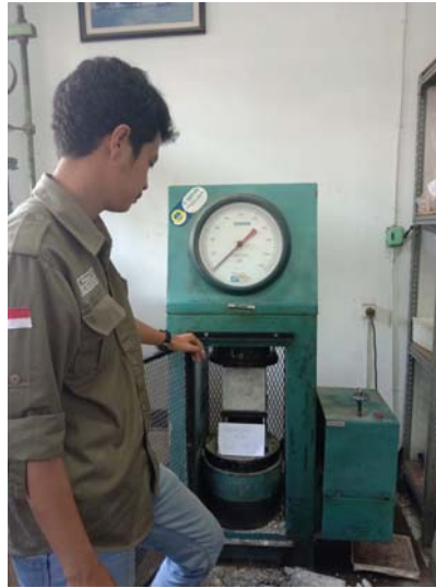
Uji tekan beton dengan 100 % Limbah Pasir Silika
