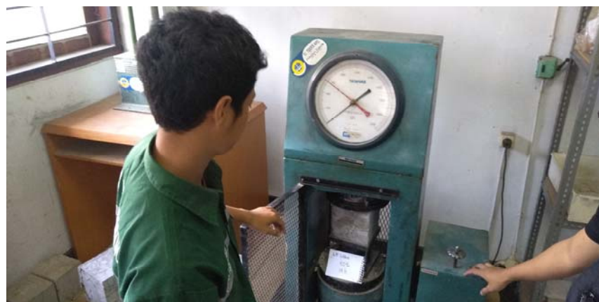
Hasil Uji Kuat Tekan Beton dengan 50 % Limbah Pasir Silika
