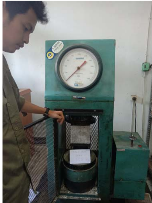
Uji Tekan Beton dengan 50 % Limbah Pasir Silika
