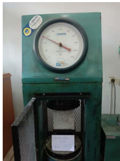
Hasil Uji tekan beton dengan 100 % Limbah Pasir Silika
