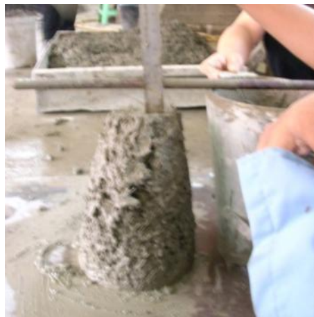
Gambar 4.1. Pengujian Slump pada beton berserat Polyolefin
