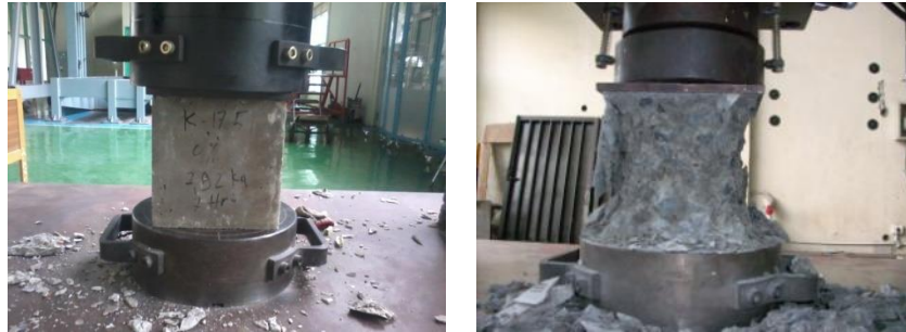
Gambar 4.4. Pengujian kuat tekan beton normal
