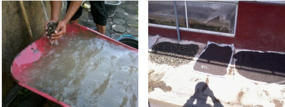
Gambar 4.1. Proses pencucian dan penjemuran agregat
