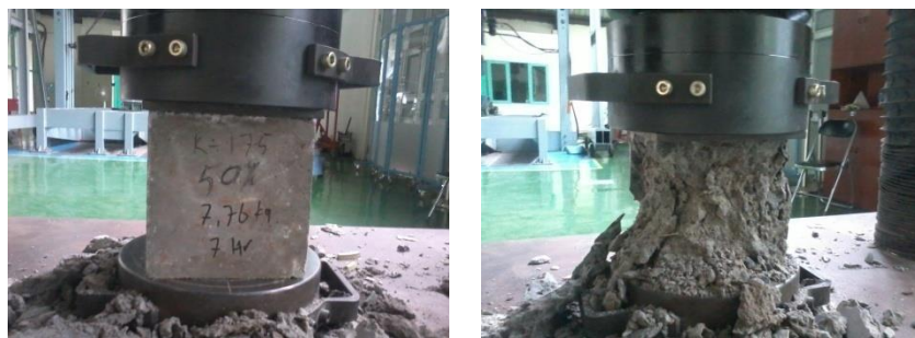
Gambar 4.5. Pengujian kuat tekan beton berserat
