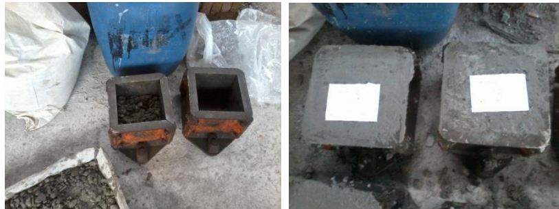
Gambar 4.2. Pencetakan Beton ke dalam cetakan kubus dan balok
