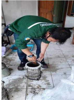
**Gambar 4.13** Proses Pengolesan Cetakan Benda Uji
