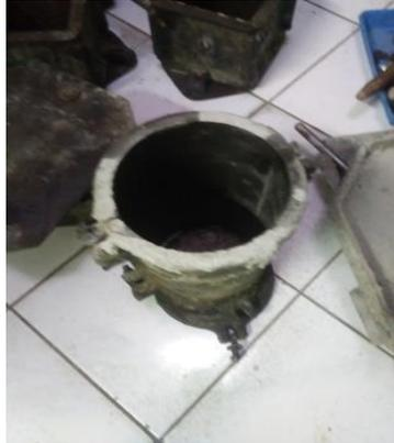
**Gambar 4.9** Cetakan Beton Silinder
