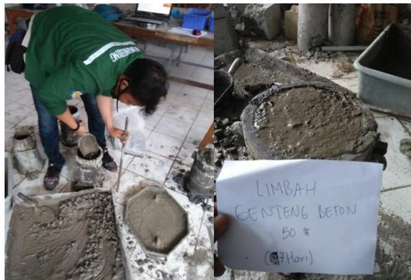
**Gambar 4.17** Pembuatan Benda Uji
