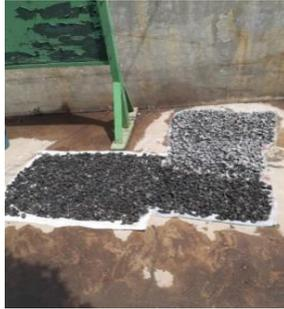
**Gambar 4.4** Proses Pencucian dan Penjemuran Agregat
